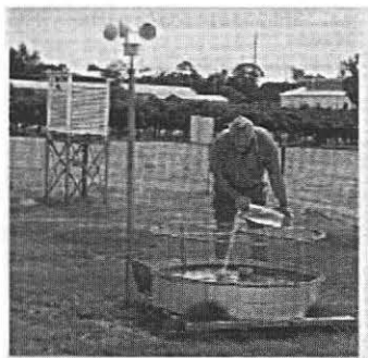
Mediciones de agua desde una bandeja de evaporación americana. Esta también puede construirse (Goodwin, 1995)
